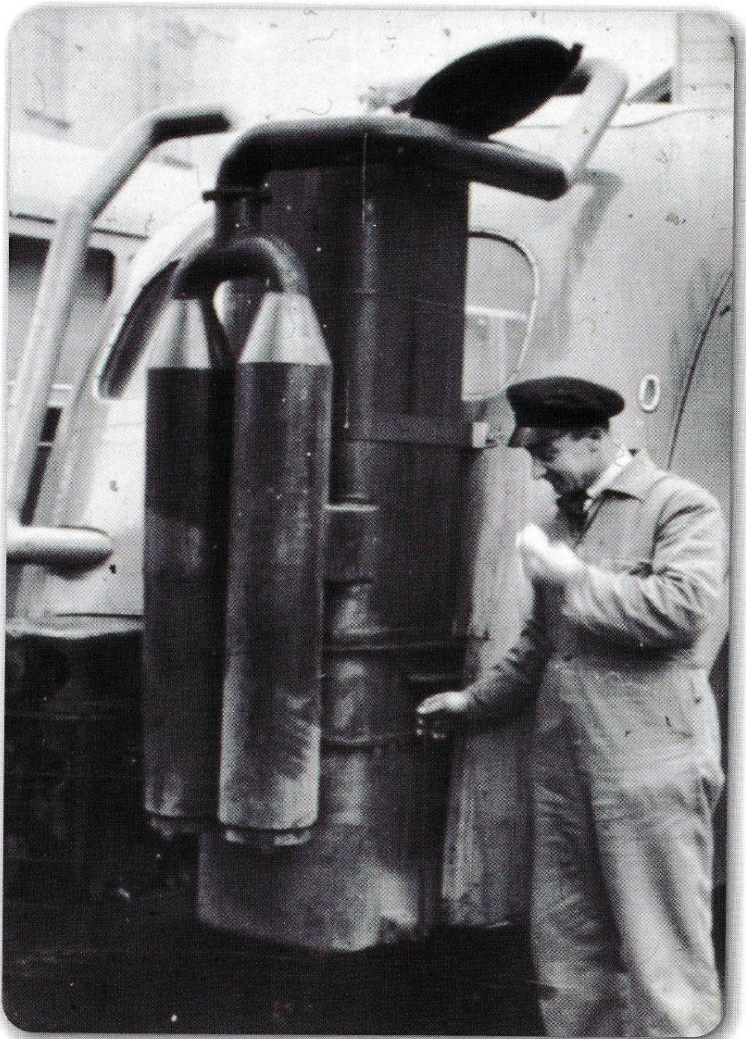
Knottgenerator i drift på en av Farmand sine busser. Foto: S R Klemmetsbys billedsamling
